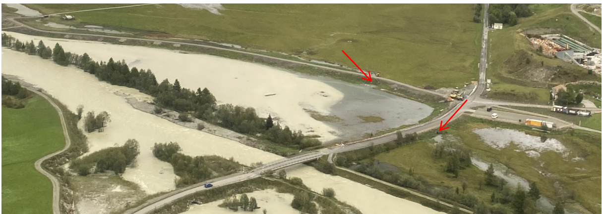
Rechts im See hat das Wasser eine andere Farbe. Dies verrät, dass es sich nicht um Inn-Wasser handelt, sondern um das Binnengewässer, welches beim rechten Pfeil durch die Röhre unter der Isellasstrasse hindurchfliesst und beim linken Pfeil mittels Durchlass auf die andere Seite des neuen Damms geleitet wird (Foto: A. Gloor, 30.8.20, siehe auch Blog vom Mai 2020).
